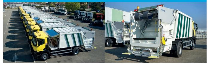
Les 28 bennes à ordures ménagères TASSÉO de FAUN, destinées à la ville de Douala au Cameroun, bénéficient d'un potentiel de compaction 6 fois supérieur à une benne classique et garantissent une sécurité des trajets accrue grâce à une excellente répartition de la collecte sur les essieux.
